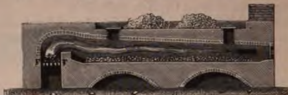
Fig. 208. — Four à soude à deux étages.
